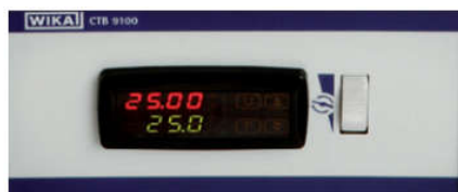
Przednia część sterownika z pokrętką prędkości mieszadła
