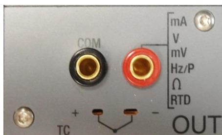
Figura 2 – Pannello modulo uscita
