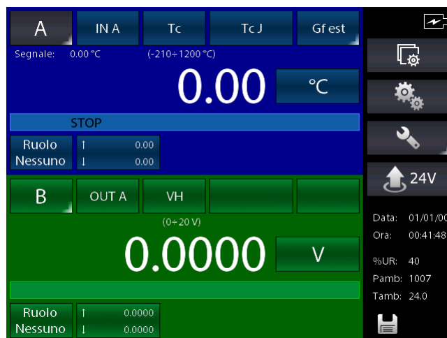
Figura 72 – Canale con funzione di mantenimento attivata
