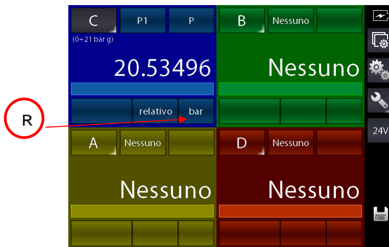
Figura 30 – Selezione parametri sensore di pressione
