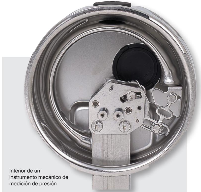
Interior de un instrumento mecánico de medición de presión
