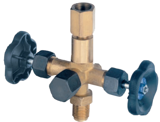
Valvola d'intercettazione con attacco di prova isolato separatamente conforme a DIN 16272, manicotto/maschio G 1/2, con attacco di prova M20 x 1,5, PN 400
