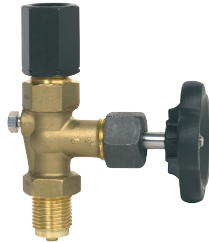
Valvola d'intercettazione conforme a DIN 16270 Manicotto con filetto destro-sinistro / maschio G 1/2, PN 250
