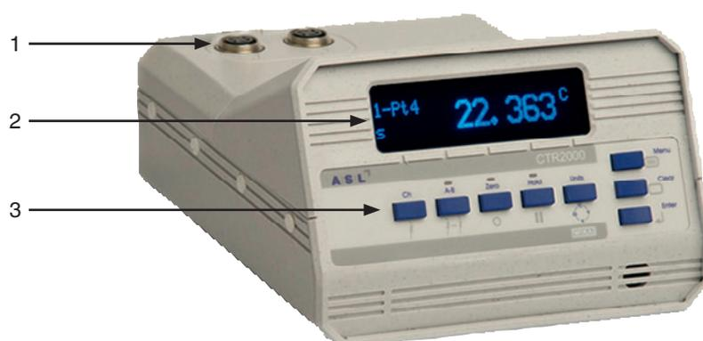
Termometro di precisione a 8 canali, modello CTR2000
