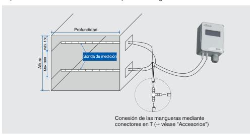
El valor Kv de la versión L depende de las dimensiones del conducto (altura y anchura) y del número de sondas utilizadas.
