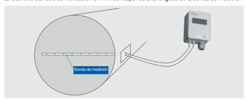
El valor Kv de la versión R depende de la longitud de la sonda de medición o de la sección transversal de la tubería.
