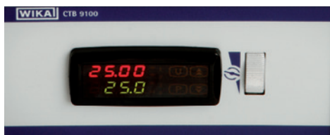
Parte delantera del regulador con rueda de velocidad de agitación
